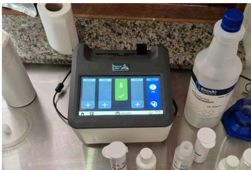
Figura 6 - Leitor AgraVision TM Pro utilizado para a análise das amostras.
